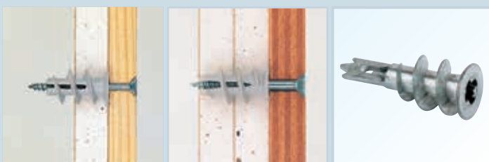
رولپلاگ حلزونی فلزی (تک لایه) رولپلاگ حلزونی پلاستیکی (دو لایه) رولپلاگ حلزونی پلاستیکی (تک لایه)
