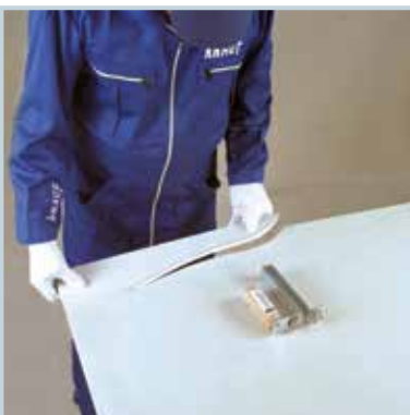
اجرای برش موج دار با دستگاه برش قرقه ای
